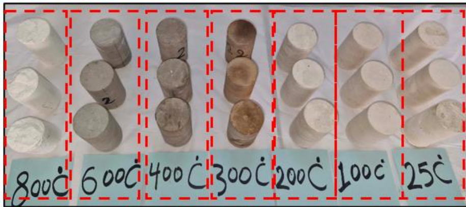
الشكل 7. عينات الصخور بعد التعرض لدرجات الحرارة العالية.
